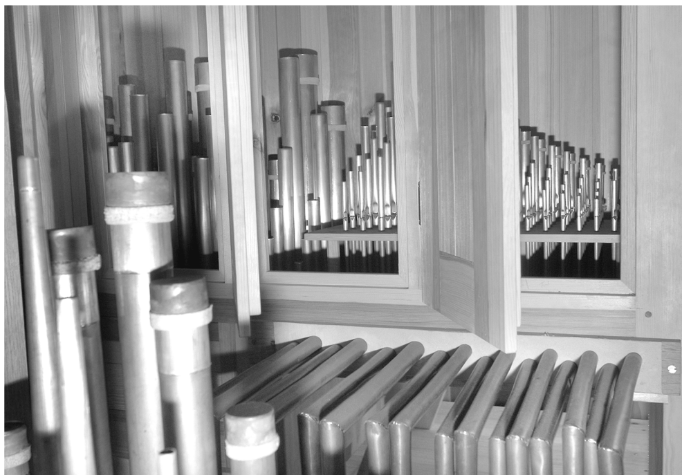
Rekonstruiertes Echo-Cornet von Hans Reil (2007) Johann Christoph Wiegleb (1738) St. Gumbertus Stiftskirche, Ansbach 14
