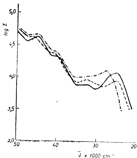
Abb. 2. Lichtabsorption von - - - - [\text{Co}(\text{Propox} \cdot \text{H})_2(\text{m}-\text{Toluidin})_2]\text{J} ————— [\text{Co}(\text{Propox} \cdot \text{H})_2(\text{p}-\text{Phenetidin})_2]\text{J} - · - · - [\text{Co}(\text{Propox} \cdot \text{H})_2(\text{o}-\text{Anisidin})_2]\text{J}
