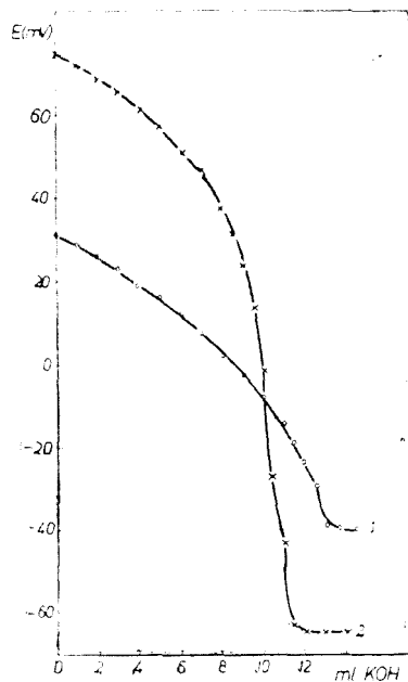
Fig. 1. \text{H}_2\text{SO}_4 with KOH titration. 1— 2 \cdot 10^{-1}\text{N} \text{H}_2\text{SO}_4 ( 10^{-1}\text{M} \text{CuSO}_4 ), \sim 10^{-1}\text{N} KOH; 2— 2 \cdot 10^{-1}\text{N} \text{H}_2\text{SO}_4 ( 2 \cdot 10^{-2}\text{M} \text{CuSO}_4 ), \sim 2 \cdot 10^{-1}\text{N} KOH.
