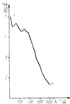
Fig. 2. Spectrul de absorbție în vizibil și UV al combinației: „c” [\text{Co}(\text{Dif})_2(\text{para-toluidin})_2]\text{NO}_3 ( \log \epsilon în funcție de lungimea de undă \lambda, m\mu )
