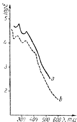
Fig. 1. Spectrele de absorbție în vizibil și UV ale combinațiilor: „a” [\text{Co}(\text{Dif})_2(\text{orto-toluidin})_2]\text{NO}_3 „b” [\text{Co}(\text{Dif})_2(\text{meta-toluidin})_2]\text{NO}_3 ( \log \epsilon în funcție de lungimea de undă \lambda, m\mu )
