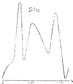
Fig. 1. Polarograma înregistrată, prin metoda derivată, pe o soluție de acid fosfo-12 molibdenic.
