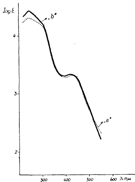
Fig. 7. Curbele de absorpție ale combinațiilor: „a” [Co(DH) 2 ( \gamma picolină) J] „b” [Co(DH) 2 ( \beta picolină) J]
